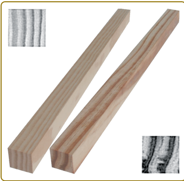
Abb. 1: Die beiden Proben ( Pinus radiata ) und je ein CT-Schichtbild
