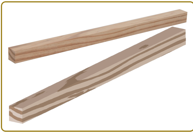
Abb. 4: 3D-Volumenmodell und die dazugehörige Probe
